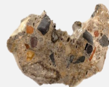
Agglomérat calcomagnésien formé par écoulement ©C. Marais
