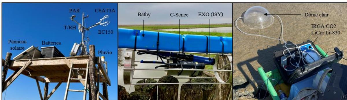
**Figure 3** : A gauche : la station EC et ses différents capteurs. Au centre : structure du bati flottant équipé des sondes multi paramètres (EXO) et pCO<sub>2</sub> (C-SENSE). A droite : chambre statique avec le dôme clair relié au système IRGA (valise) déployé in situ sur la vasière aux deux saisons étudiées.
